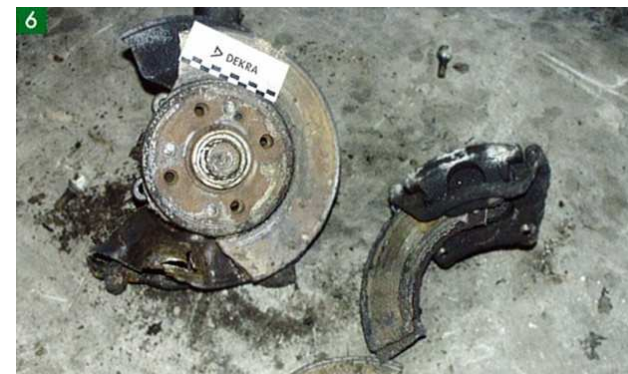
Wyłamana tarcza hamulcowa
